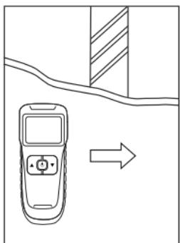
Passez toujours deux fois avec l'appareil sur l'objet trouvé. Les passages doivent être effectués en sens opposés. Après le calibrage, glissez l'appareil lentement le long du mur en direction horizontale (voir l'illustration).
