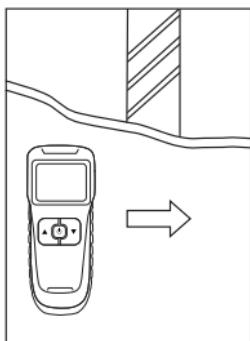
Das gefundene Objekt muss jeweils zwei Mal mit dem Gerät überquert werden. Die Überquerung erfolgt hierbei in entgegengesetzte Richtungen.
