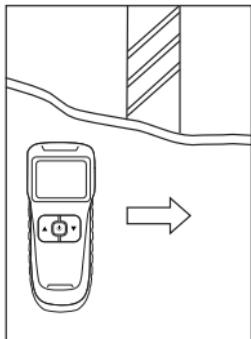
Het gevonden object moet steeds tweemaal met het apparaat worden overkruist. De overkruising gebeurt hierbij in tegengestelde richtingen.
