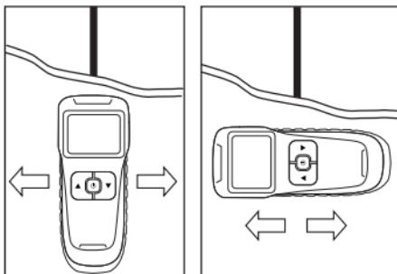
Si le symbole de la foudre est affiché en addition au mode **AC**, l'objet détecté est une **conduite électrique sous tension**.
