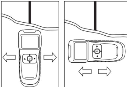
Als er naast de **AC**-modus en de balkweergave nog een bliksemsymbool verschijnt, is het gevonden object een **stroomvoerende elektrische leiding**.
